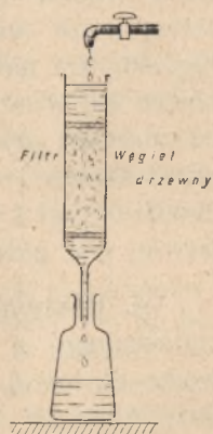
Fig. 47. Filtrowanie wody do picia przez warstwę węgla drzewnego.
