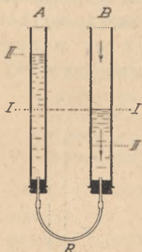
Fig. 21. Połączone naczynia. W dwu naczyniach A i B połączonych ze sobą rurką R poziomy cieczy przesuwają się, jeśli ciśnienie powietrza nad cieczą w obu rurkach A i B nie jest równe.
