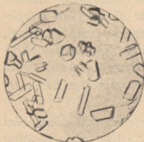
Fig. 51. Krystalizacja szybka (np. siarczanu miedzi) daje drobnokrystaliczny osad.
