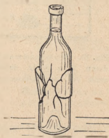
Fig. 60. Powiększenie objętości krzepnącej wody powoduje rozsadzenie flaszki.
