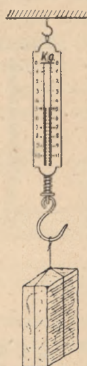
Fig. 3a. Waga sprężynowa, skalibrowana na \frac{1}{2} \text{kg} .
