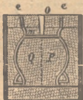
Rys. 7. Zafornowany garnek żelazny w przekroju. o otwór do wlewania metalu (lej), e otwory powietrzne.
